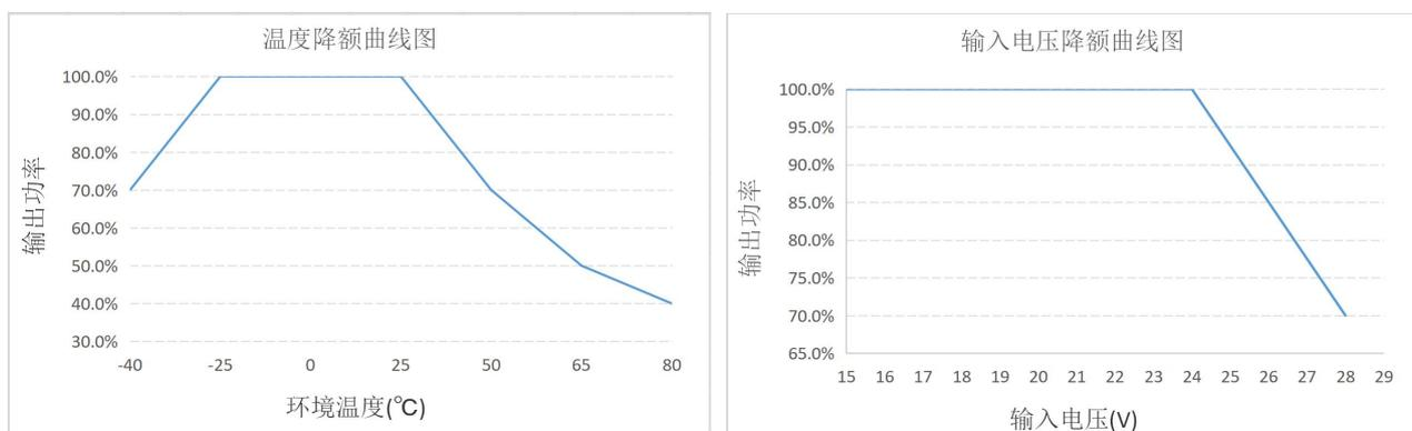
注：①对于输入电压为 15~28VDC,需在温度降额的基础上进行输入电压降额；
